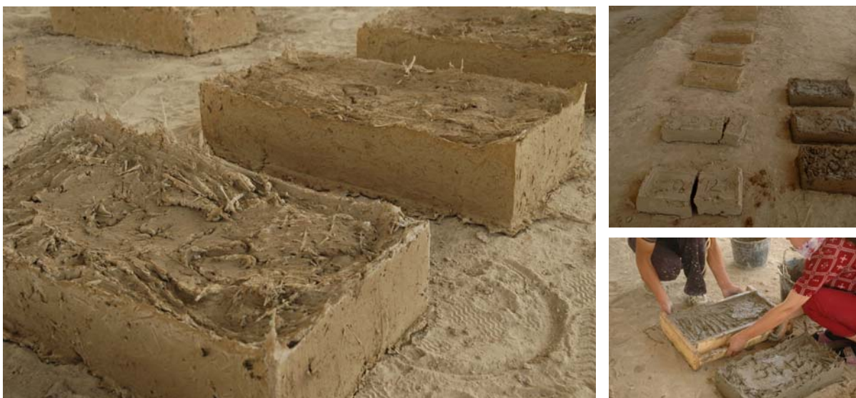
Briques de terre crue produites avec différents dosages de paille
